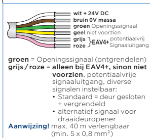
Afbeelding 3.6.2-1: Bekabeling blueMatic EAV4/EAV4+ met "Vingerscanner ekey dLine" (vleugelzijde)
